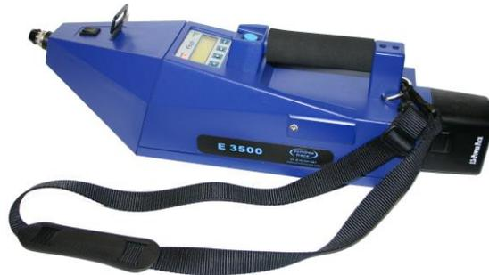
E3500 は化学蛍光反応を利用した携帯式爆発物探知装置(ETD)です。サンプリング方法は、爆発性物質の蒸気を吸引する蒸気モード、爆発物の痕跡をスクリーンに移動させて採取する粒子モードの2通りの方法があります。
